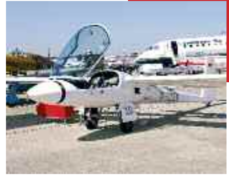
■ Stemme, planeur autonome grâce à un moteur incorporé.
